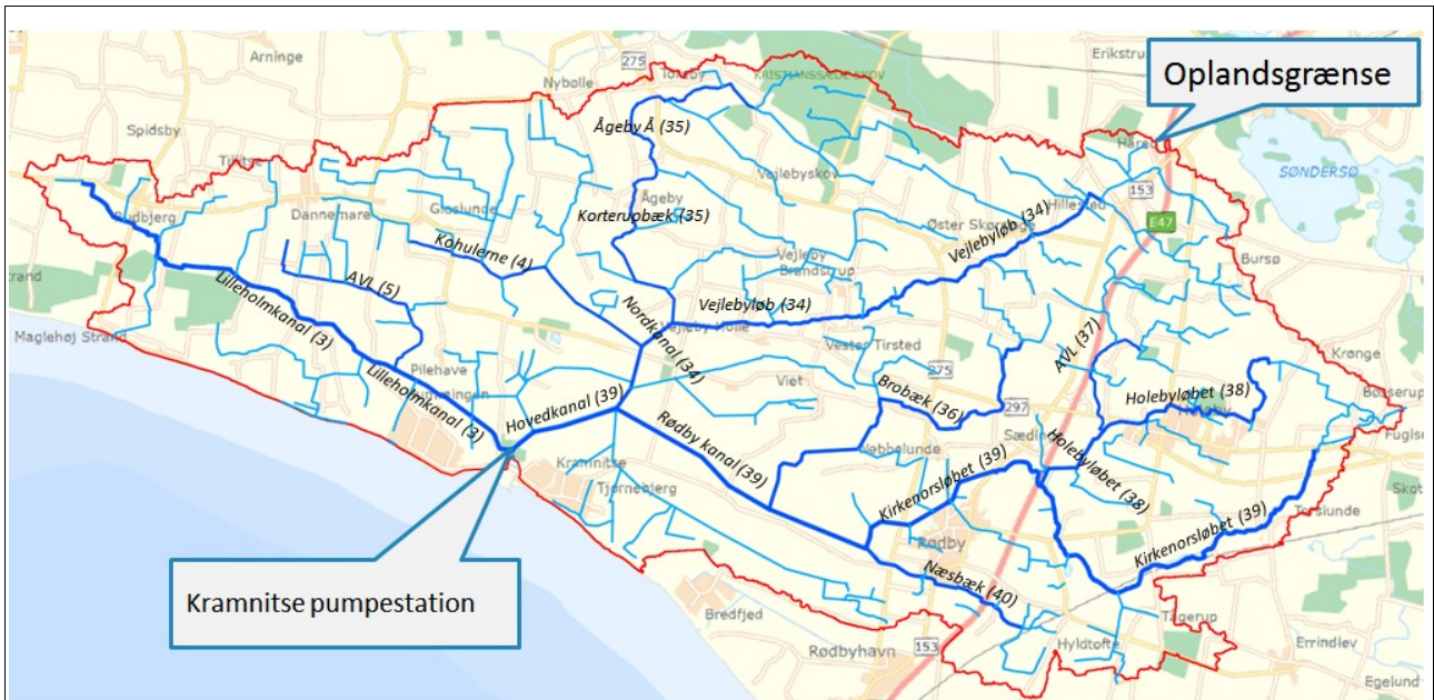
Figur 2: Kanalsystemet i oplandet til Kramnitse pumpestation. Hovedkanaler markeret med mørkeblå, andre kanaler med lyseblå.
